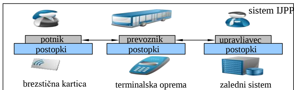
Slika 4: Osnovni elementi IJPP sistema s pripadajočimi postopki in telekomunikacijsko opremo znotraj sistema IJPP
