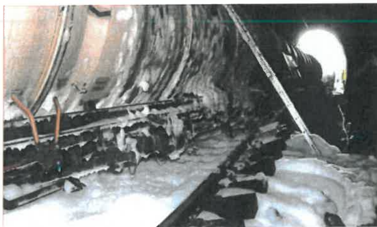
Slika 8: Cisterna, prekrita s srednje težko peno za preprečitev hlapenja
